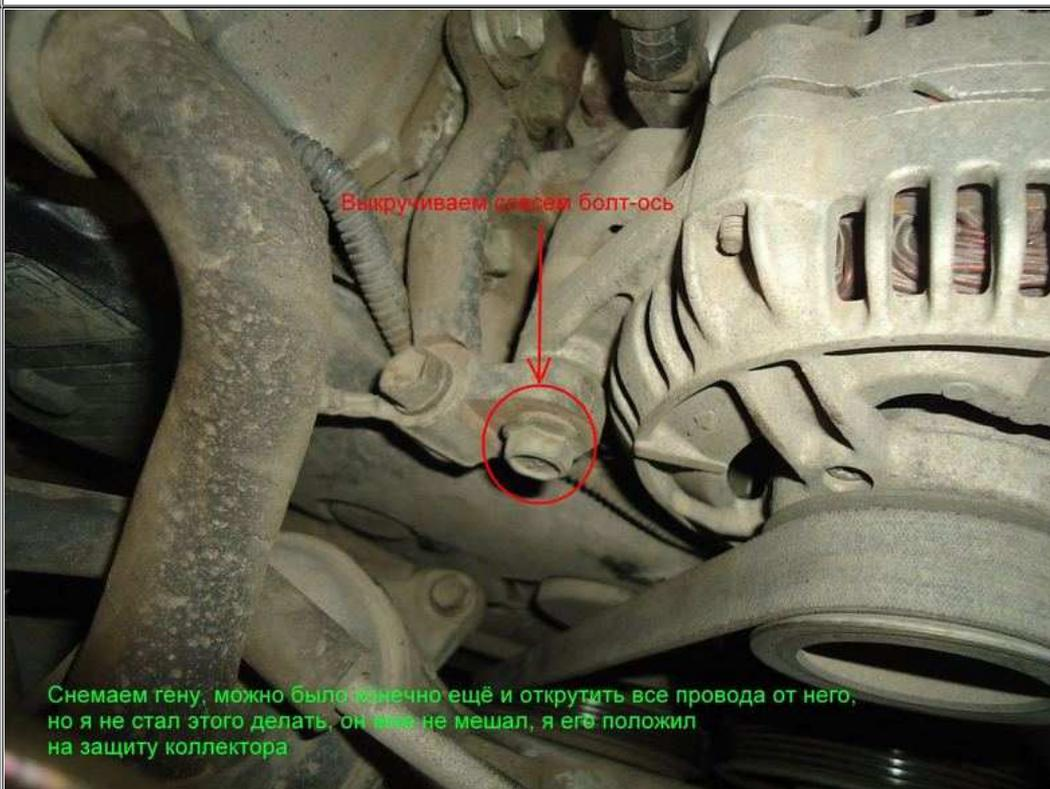
Выкручиваем сальник болт-ось
