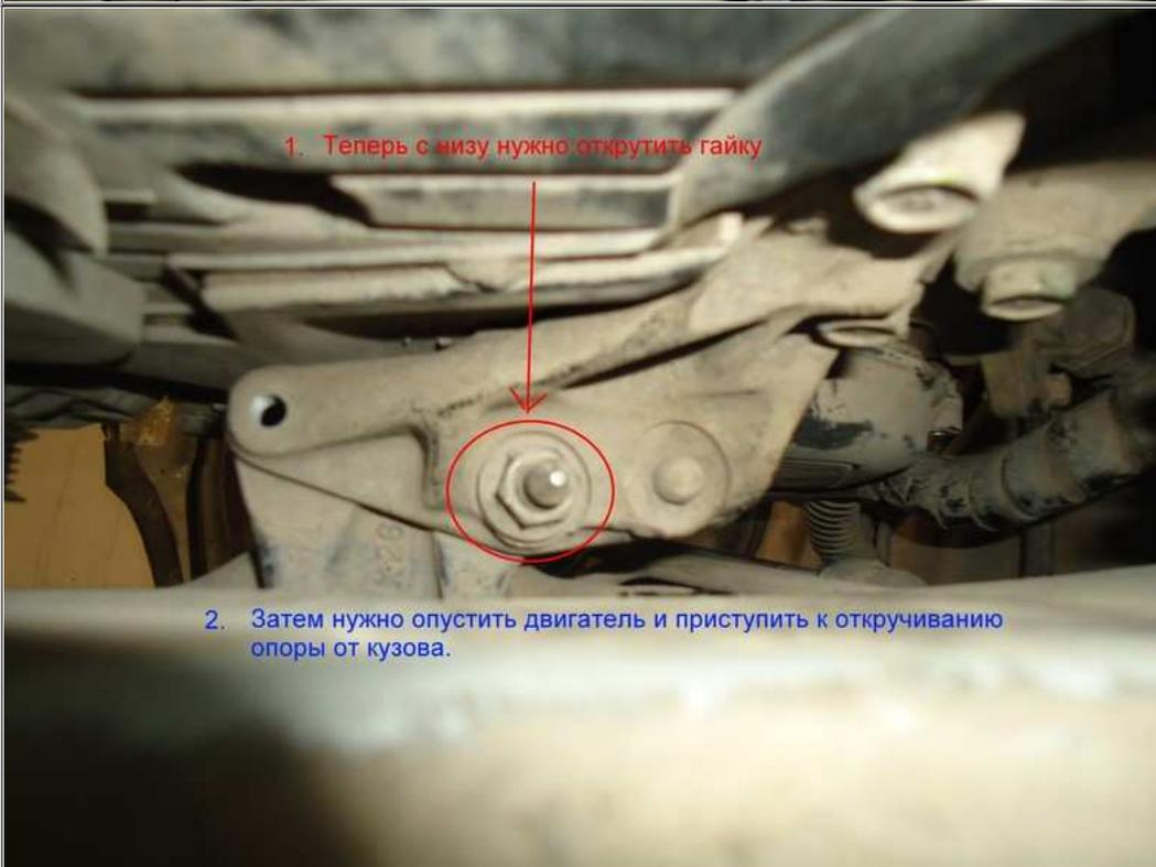
2. Затем нужно опустить двигатель и приступить к откручиванию опоры от кузова.
