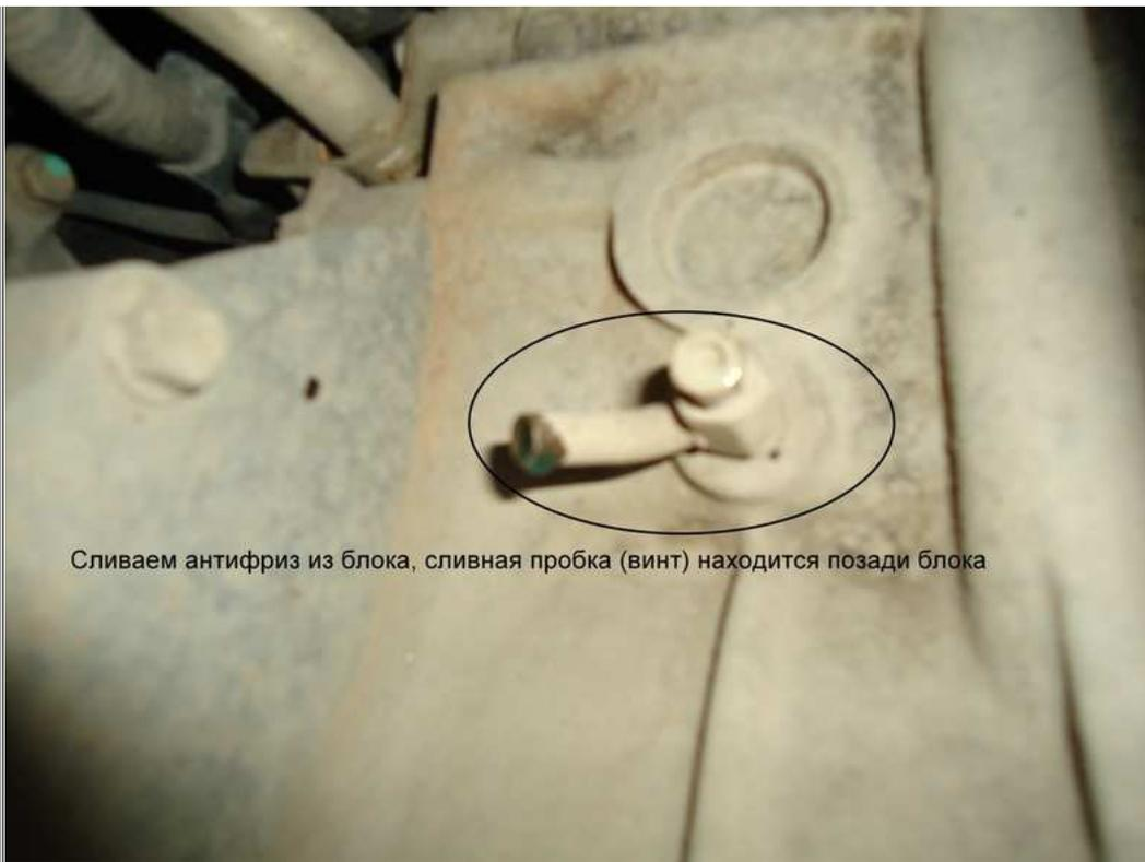
Сливаем антифриз из блока, сливная пробка (винт) находится позади блока
